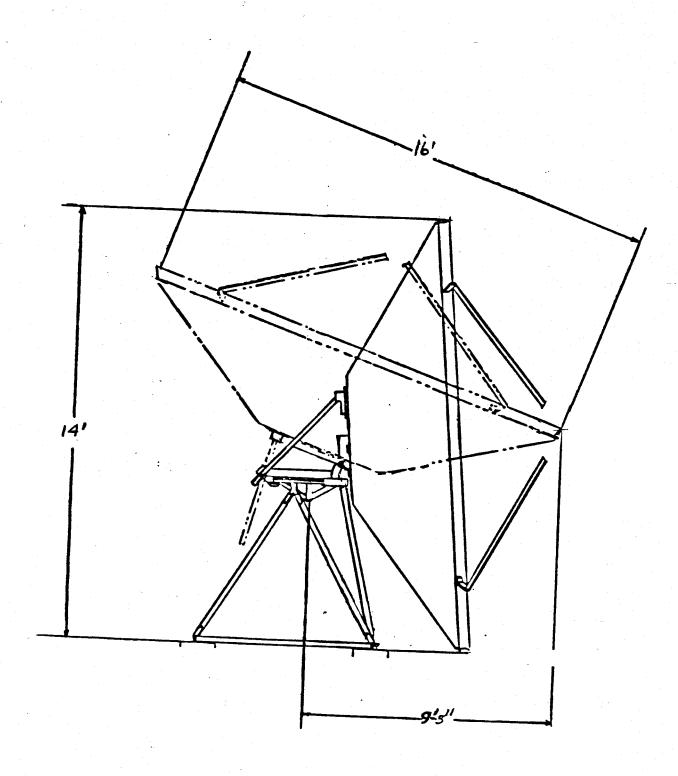
5.0 Meter RS/ ANTENNA SIDE VIEW (CLEARANCES).
